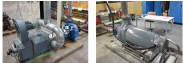
Links: Die alte Pumpe mit originalelem Gleichstrommotor, Kühlung und Absaugung. Rechts: Die neue Pumpe in einem Gehäuse. Foto: Topmotors
